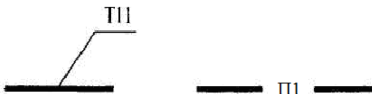
Рисунок 6 Буквенно-цифровое обозначение трубопроводов или воздуховодов
